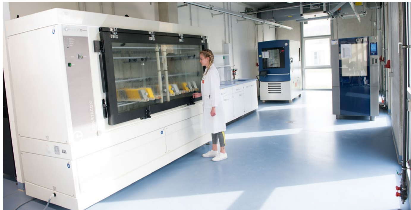
Durch die verschiedenen Laborprüfungen, hier Prüfkammern für Korrosions- und Klimawechselprüfungen, können die einzelnen Vorbehandlungs- und Beschichtungsverfahren untereinander abgeprüft und verifiziert werden. Fotos: IFO/Mantel
