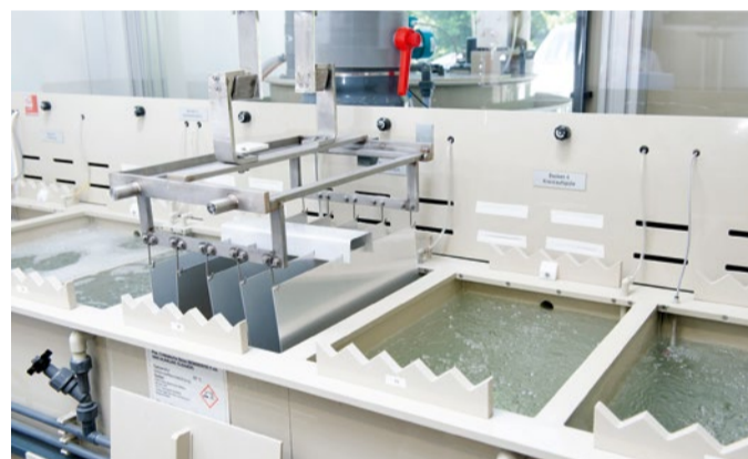
In der automatisierten nasschemischen Vorbehandlungsanlage werden Beschichtungsversuche durchgeführt, um im Rahmen einer Nutzwertanalyse den optimalen Prozess zu finden.
