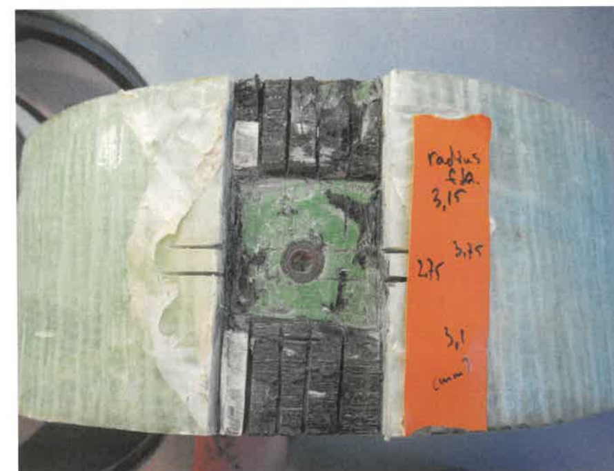
Bei der kathodischen Delaminationsprüfung wird der Prüfkörper angebohrt, ein Plastikrohr darüber dicht aufgesetzt und mit einem Elektrolyten befüllt, dann wird eine Potentialdifferenz aufgebaut, sodass die kathodische Reaktion begünstigt wird. Nach der Prüfung wird der Bereich der Enthftung durch das Ablösen der Beschichtung bewertet.
