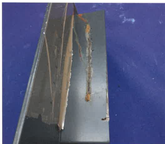
...beim Prüfkörper mit 2-Schichtaufbau keine oder nur geringere Oberflächenveränderungen auftraten (Abb. 3).
