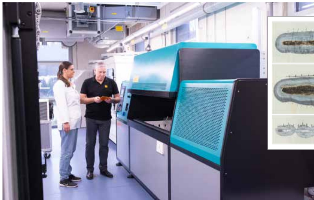
Klimakammer zur Durchführung einer Klimawechselprüfung mit Kälteaggregat und aufwändiger Regeltechnik der Temperatur, der Feuchtigkeit und der Salzsprühphasen nach DIN EN ISO 11997-3 / VDA-neu.
