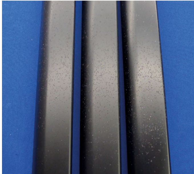
Prüflinge nach der Multisteinschlagprüfung: Die beiden linken Proben haben den nach der DIN EN ISO 20567-1 kleinstmöglichen Kennwert (0,5), während die rechte Probe mit dem Kennwert 1,0 bewertet wurde – die Grenzwerte für die Zulässigkeit sind jedoch nicht definiert. Foto: IFO
