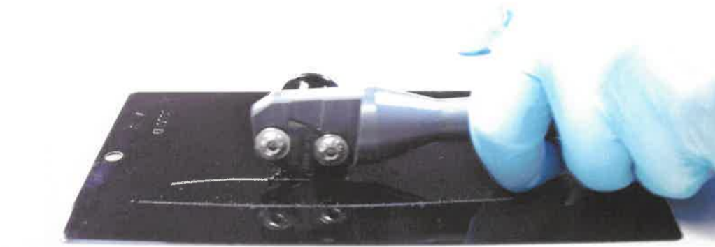
Bei der händischen Anfertigung von Ritzen ist eine mikrometeregenaue Ritztiefe auch mit viel Übung eher zufallsbasiert, daher rücken automatisierte Verfahren immer mehr in den Vordergrund. Foto: Redaktion
