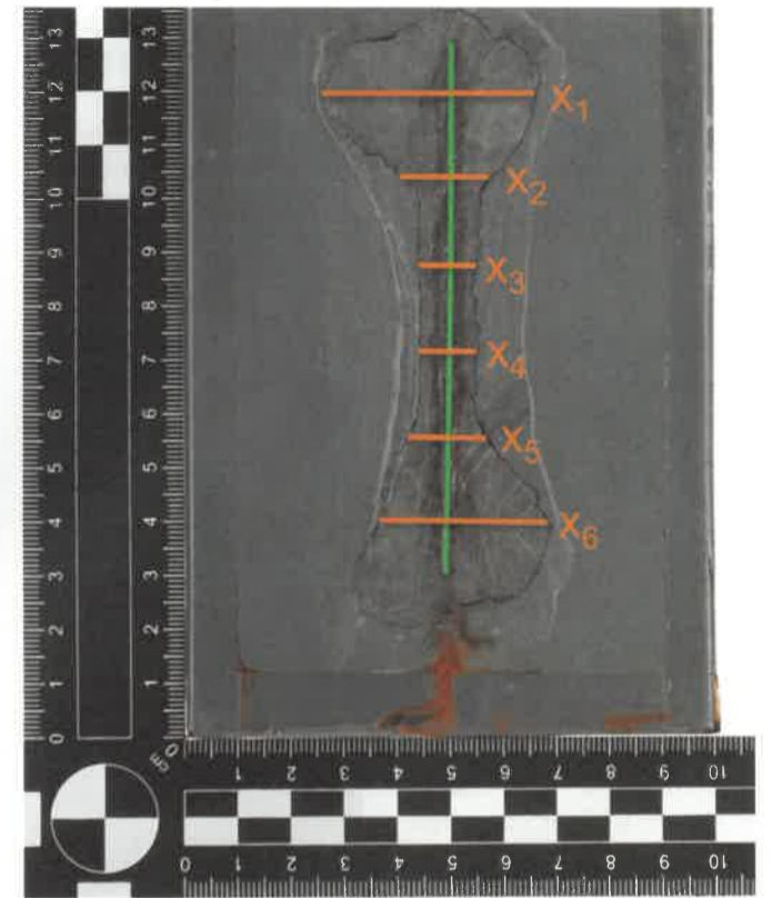
Die Vermessung der Enthftung am Ritz erfolgt an mindestens sechs gleichverteilten Messstellen entlang der Ritzverletzung.:
