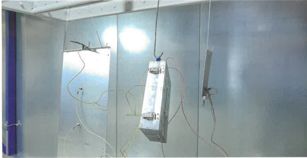
Bleche mit Temperatursensoren im Einbrennofen: Um die notwendigen Verweilzeiten im Ofen zu ermitteln, können Anwender mit einem mobilen Temperaturprofilssystem, einem sogenannten Oven Tracker, arbeiten.
