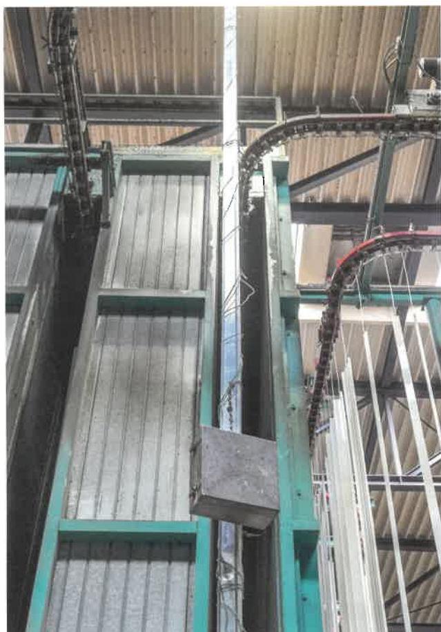
Für die Messung empfiehlt es sich, eine Traverse mit verschiedenen Referenzen oder ein entsprechendes Profil bereit zu halten. Hier dient ein Aluminium-Hohlprofil als Referenz an einer Vertikalanlage.
