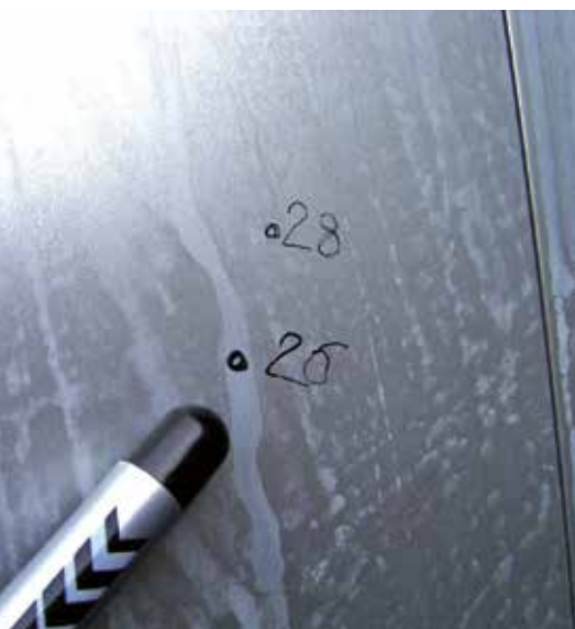
Verätzung einer anodisierten Oberfläche durch ein ungeeignetes Reinigungsmittel.
